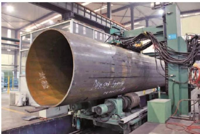
渤海装备 X80 直缝埋弧焊钢管
