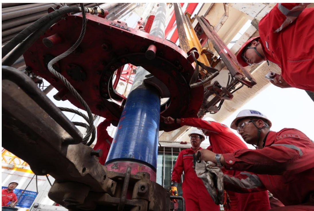
塔里木油田施工人员进行下套管作业。
