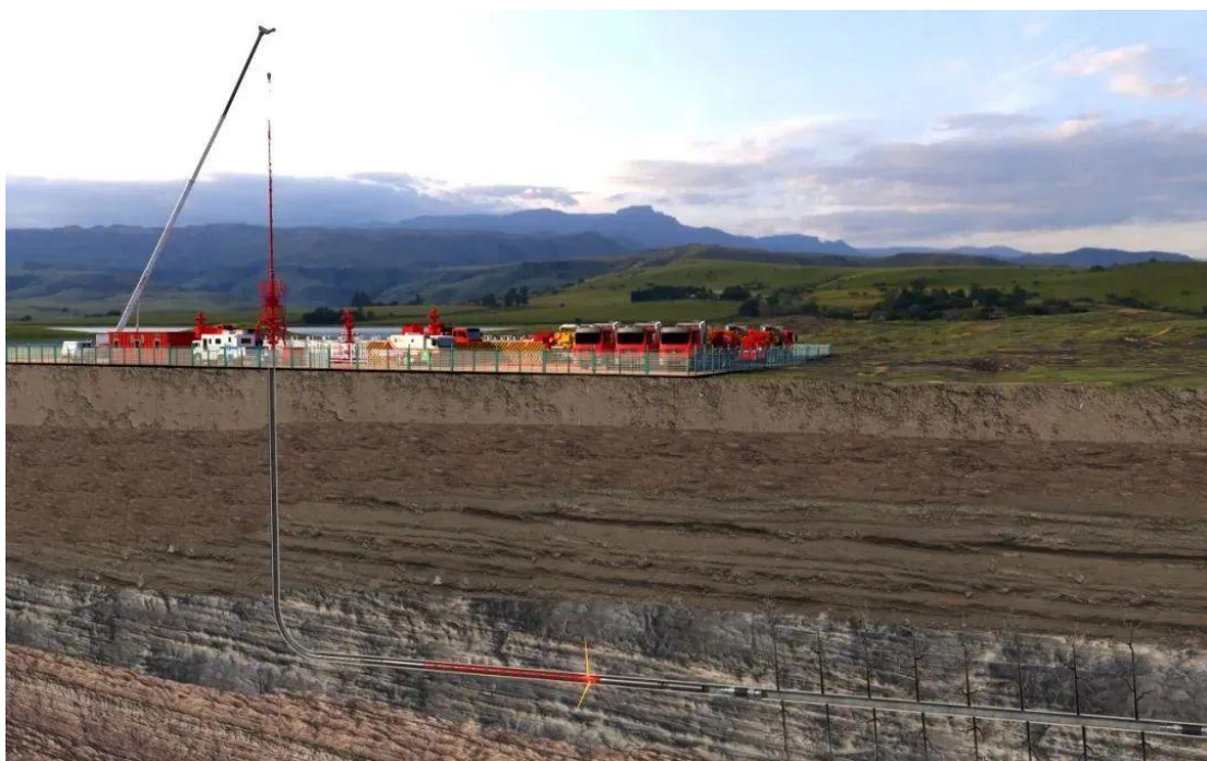
▲“先锋”桥射联作技术作业示意
